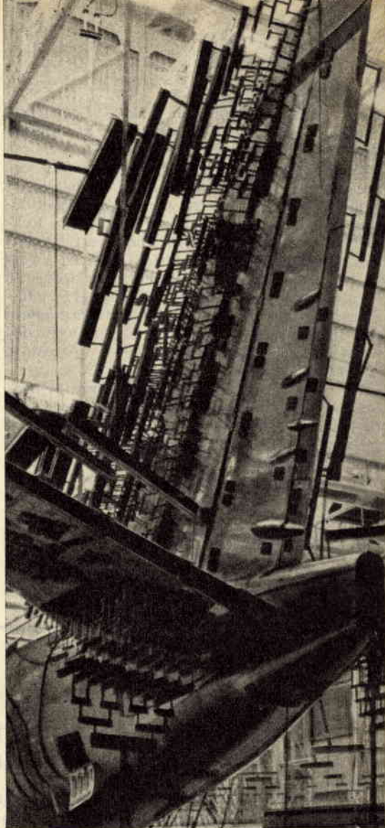
Dopo i tragici incidenti dei Comet, le prove di torsione e resistenza sono state spinte ai limiti estremi. Nella foto: il timone direzionale di un "880" sottoposto a rigorose prove nelle officine Convair.
